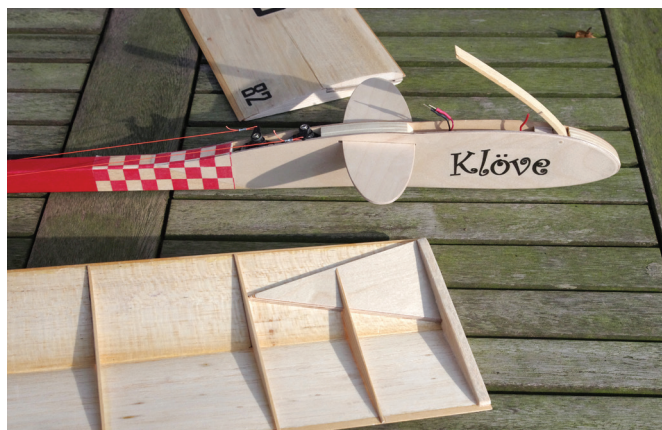
Pogled na bajonetni način spajanja krila s trupom in odprt pokrov prostora za baterijo in sprejemnik v nosu trupa
