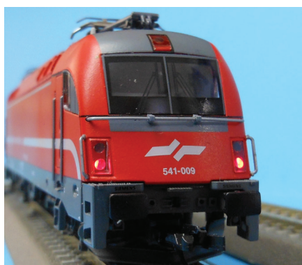
Zadnja dva rdeča žarometa v analognem sistemu upravljanju na drugi kabini svetita gledano v smeri vožnje.
