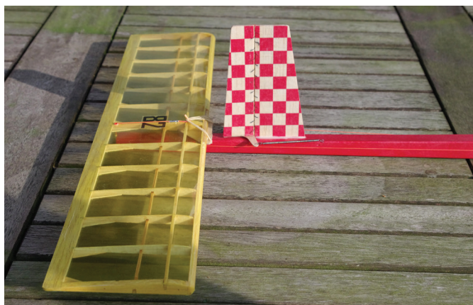
Vsak servomehanizem deluje z enojno povezavo proti napeti elastiki pri višinskem stabilizatorju in natezni vzmeti pri smernem stabilizatorju.
