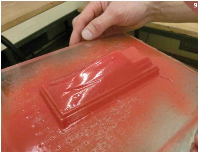
Karoserija, narejena po postopku vakuumiranja
