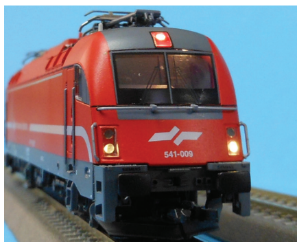
Sprednji trije beli žarometi so pri vožnji v analognem načinu upravljanja v osnovni funkciji in na prvi kabini svetijo v smeri vožnje. Pri osnovnem modelu brez vgrajenega dekodirnika v žarometih svetijo samo kratke luči, in to sorazmerno s hitrostjo. Z vgrajenim dekodirnikom in pri digitalnem napajanju žarometi svetijo konstantno tako med vožnjo kot v mirovanju.
