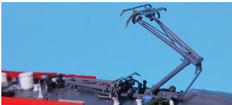
Tokovni odjemniki so kovinski in se med sabo razlikujejo po širini drsne površine. Model lahko napajamo tudi prek zgornjih tokovnih odjemnikov.
