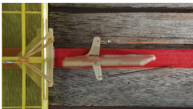
Natezna vzmet je iz pribora za modelne železnice. Pletena ribiška vrvica je s koščki aluminijaste cevke prilagojena na ustrezno dolžino.
