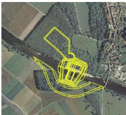
Slika 2 • Levo – ortofoto posnetek z vrisanim območjem posegov za gradbeno jamo HE Brežice; desno – isto območje, zajeto z numerično mrežo hidravličnega modela 2D (Rak, 2012)
