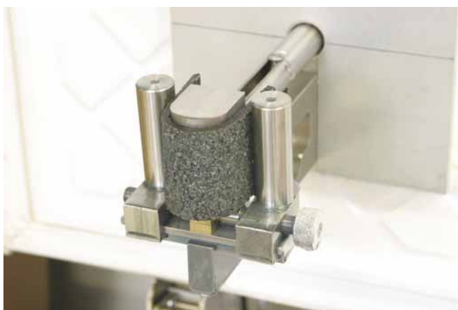
Slika 5: Določevanje upogljivosti bitumenskih trakov pri nizkih temperaturah Figure 5: Determination of bituminous sheets flexibility at low temperatures
