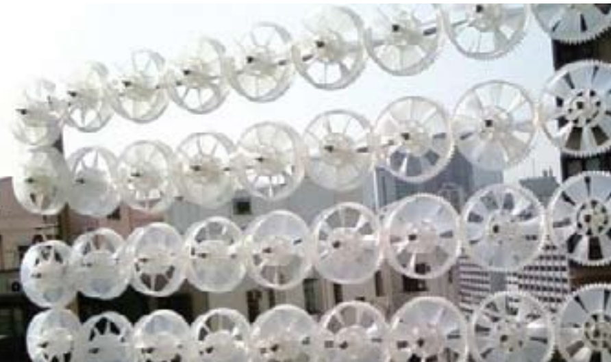
Mikrovetrne turbine, ki jih je mogoče združevati v večje nize.
