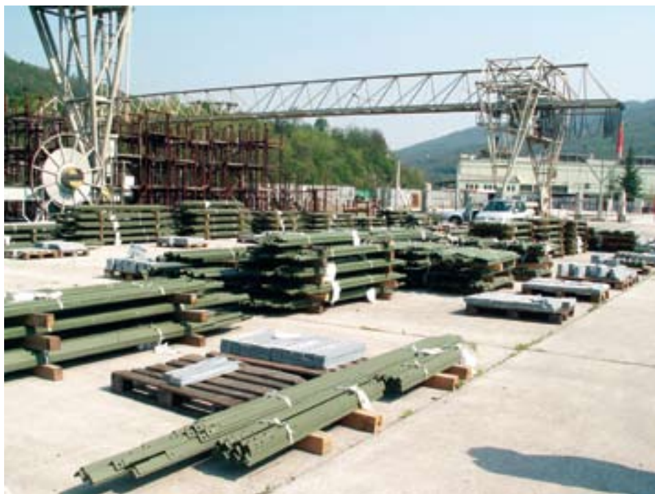
Pocinkana in pobarvana konstrukcija daljnovidnih stebrov.
