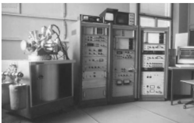
Slika 10: Augerjev rastrski spektroskop podjetja PHI, SAM, 545A v laboratoriju za površinsko analizo na Inštitutu Jožef Stefan Odsek za tehnologijo površin in optoelektroniko
