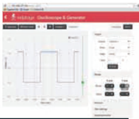
Referenčni 1 kHz signal z napetostjo 2 Vpp, kot ga zajameta Voltcraft in RedPitaya.
