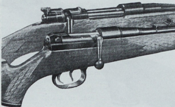
Primerjava sistema Mauser mod. 98 s sistemom Mauser 66, ki je 9 cm krajši
