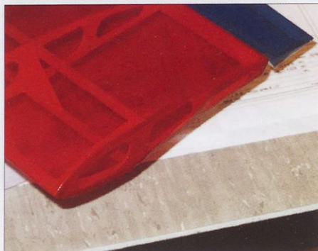
Zadnje rebro na krilu je treba okrepiti, da ne pride do zvrtja.
