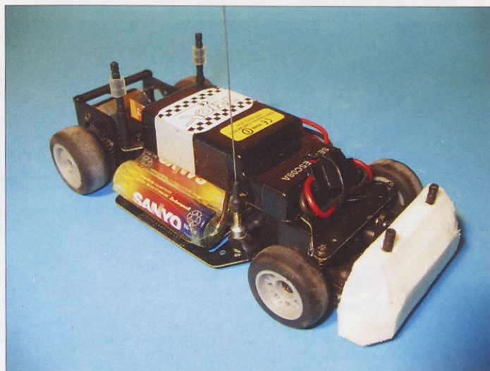
Nosilec antene predelamo in anteno zamenjamo z doma izdelano iz tanke jeklene žice, ki jo z majhno pušo pritrđimo na avtomobil.
