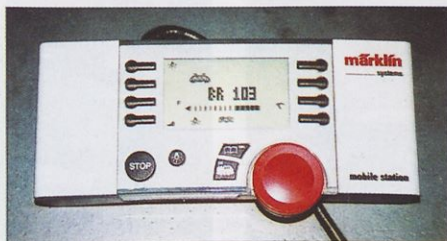
Centrala Mobile Station predstavlja začetek tretje generacije Märklinovega digitalnega sistema. Z njo bomo lahko hkrati upravljali deset lokomotiv in bo nudila veliko možnosti. V pomoč je tudi večnamenski prikazovalnik na sredini.
