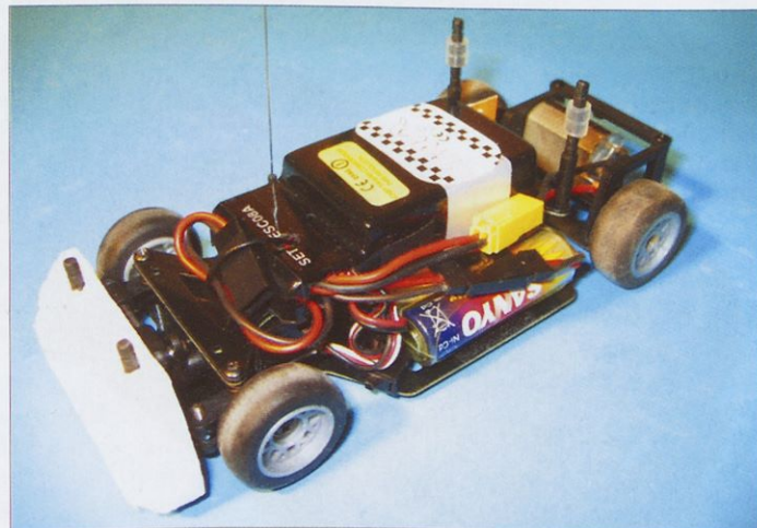
Serijske gumijaste obročke, ki držijo karoserijo, nadomestimo s koščki silikonske cevke za gorivo. Po teh predelavah je naš mali dirkalnik pripravljen za dirke.
