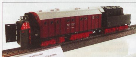
Digitalni model hitre parne lokomotive DB 03 v merilu 1 : 32 (1) iz tretjega železniškega obdobja. Novi Märklinov model ima različne svetlobne in zvočne efekte. Pogonja ga motor RE-max, kakršne uporablja NASA v vesoljski tehnologiji.
