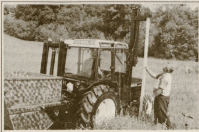
Traktorski priključek za postavljanje in puljenje vinogradniških in sadjarskih stebričkov, za katerega je Alojz Grabrovec prejel zlato medaljo
