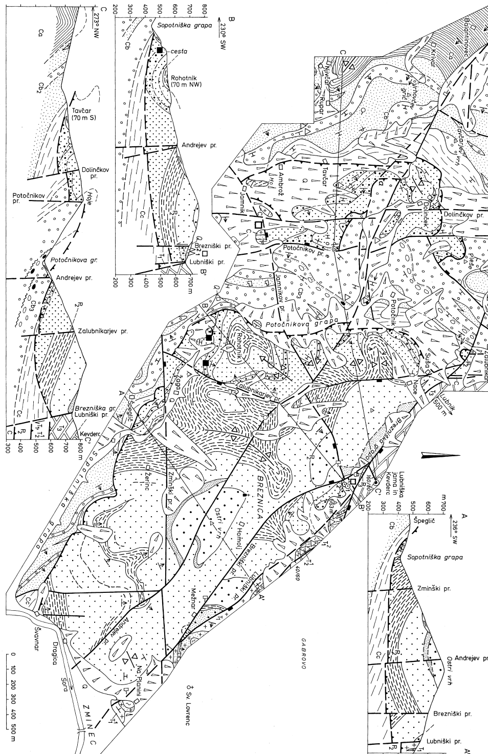
Sl. 3 Geološka karta območja Breznica - Hoje in geološki prerezi Fig. 3 Geological map Breznica - Hoje area and geological sections
