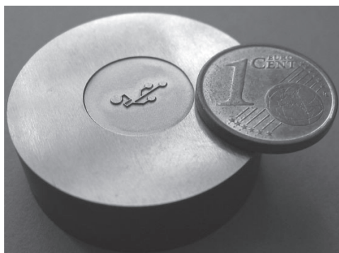
Sl. 5. Orodje za masovno proizvodnjo izdelano s PPME
