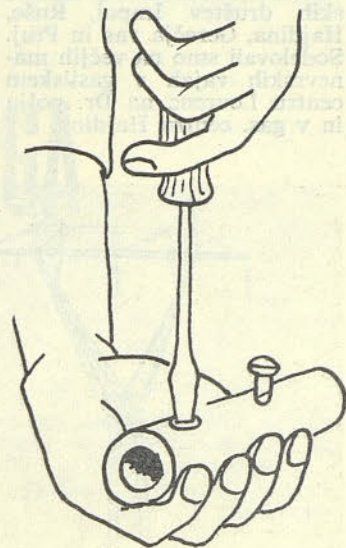
Slika 5. — NAPAČNO! — Nevarno je, če male obdelovance držimo v dlani, ker izvijač lahko spodleti in poškoduje roko. Zato vedi, da je manjši obdelovanec treba nasloniti npr. na delovno mizo ali ga pa vstaviti v primež.
