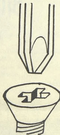
Slika 4. Križni izvijač ima posebno obliko, uporabljamo ga le za vijake z ustrezno glavo. V takih primerih ne uporabljamo navadnih izvijačev.
