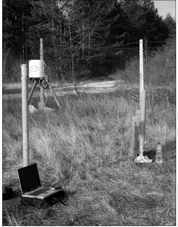
Slika 1. Merjenje padavin in zbiranje mesečnega vzorca za izotopske analize kisika.
