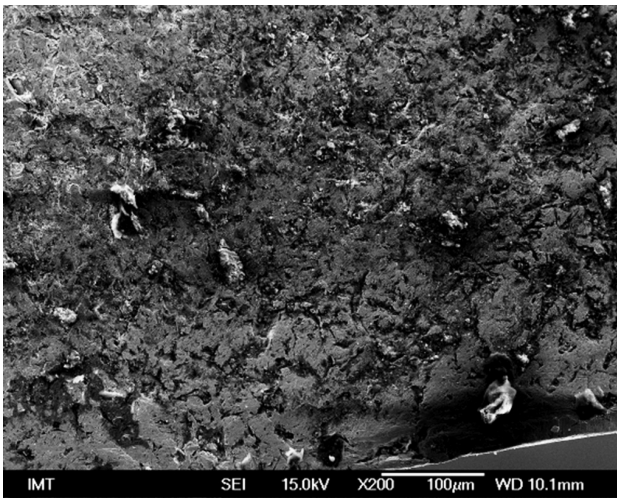
Figure 10: SEM image of plastically deformed surface area 1.1 Slika 10: SEM-posnetek deformirane površine, označene z 1.1
