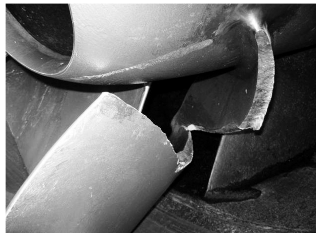
Figure 2: Damaged impeller blade Slika 2: Poškodovana lopatica rotorja
