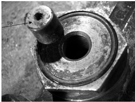
Figure 2: Drawing die (matrix) with a tip (pressure type) Slika 2: Orodje za vlečenje (matrica) s konico (tlačne vrste)
