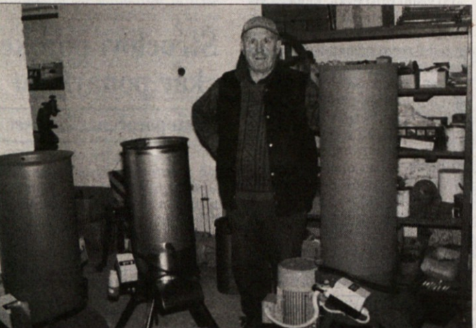
DROBILNI STROJI TUDI ZA TUJI TRG - Podjetje Intelekt iz Šentrupe, ki ga vodi podjetnik Maks Kurent (na skiki), že nekaj let izdeluje drobilne stroje za krmilno hrano, ki so bili dobro sprejeti na domačem in tujem trgu (Hrvaška). Ker bodo v Intelekti, ki sicer izdeluje tudi drugo kovinsko opremo, v kratkem povečali proizvodnjo, bodo na tuje lahko izvozili še več strojev. Poleg 75-litrskega drobilca bo to tudi 85-litrski v več izvedbah. (Foto: S. Dokl)
