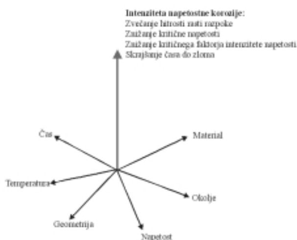
Slika 8: Shematski prikaz neodvisnih parametrov, ki vplivajo na odvisne faktorje intenzitete napetostne korozije
