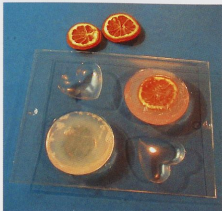
Slika 4. Staljeno prosojno milo nalijete v oba zrcalna kalupa; v enega pred vlitvanjem položite rezino suhega sadja.
