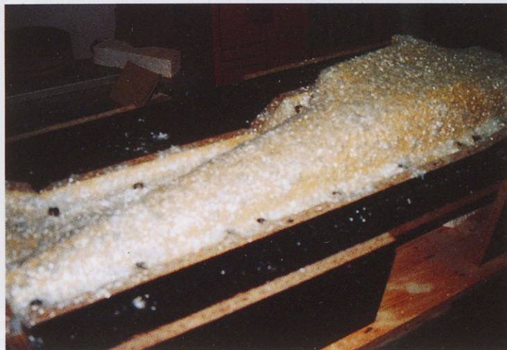
Slika 4. Zmes steklenih vlaken in kita naneseemo po celotni površini orodja. Pazimo, da ne zamažemo notranjosti navojnih matic in puš.
