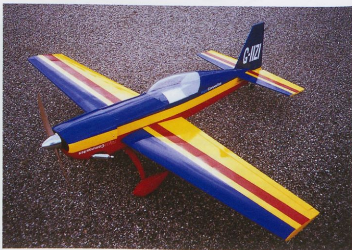
Avtorjevo extro 300S z razpetino kril 1,5 m poganja štiritaktni motor 13 cm 3 . Akrobatski model je težak 2,3 kg in ima odlične letalne lastnosti. Barvna shema je skrbno izbrana, da se model v zraku lepo vidi v vseh mogočih položajih. Vsi deli ELSV (pokrov motorja, ogljikovo podvozje in copatki) so izdelani v domači delavnici.
