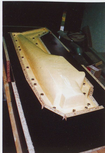
Slika 2. Pramodel in delilno ravnino natančno premažemo z gelcoatom G 56.
