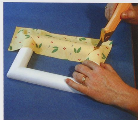
Slika 3. Blago s topo stranjo rezila modelarskega noža zatlačite v reže na vogalih okvirja.
