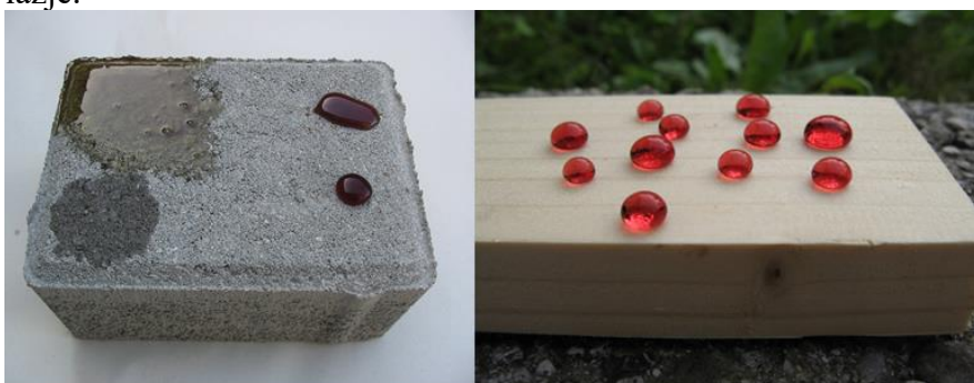
Slika 61: Nevidna zaščita pred vlago in umazanijo. Olje in vino se na zaščiteni površini betona in lesa oblikujeta v kapljice in ne moreta prodreti v notranjost.
