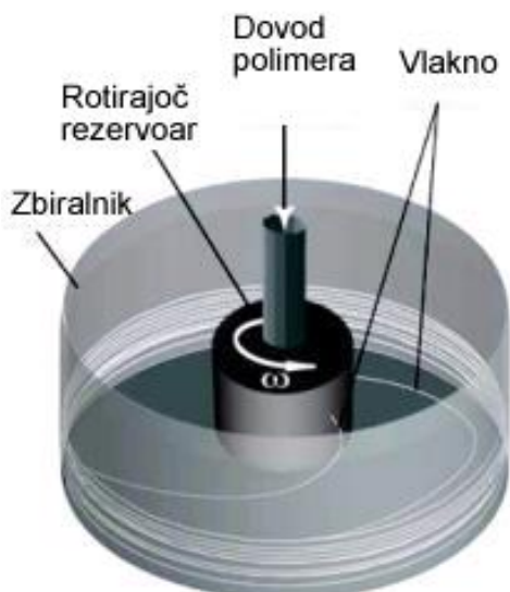
Slika 28: Shema rotacijske izdelave nanovlaken. 70
