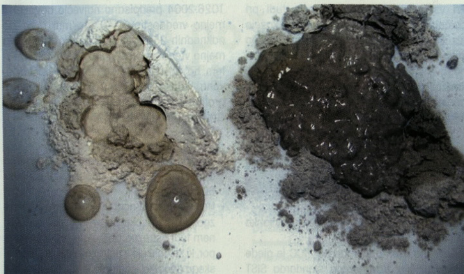
Slika 6 • Preskus hidrofilitnosti uporabljenih apnenčevih mok C (levo) in apnenčevih mok L (desno)
