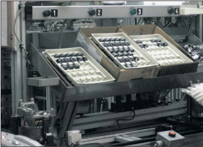
Slika 6. Paleta na montažnem mestu – bati, gredi in puše
