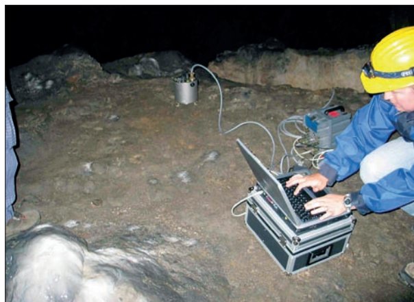
Fig. 2: Seismic noise measurements in Črna Jama in 2007 (Photo: S. Šebela).
