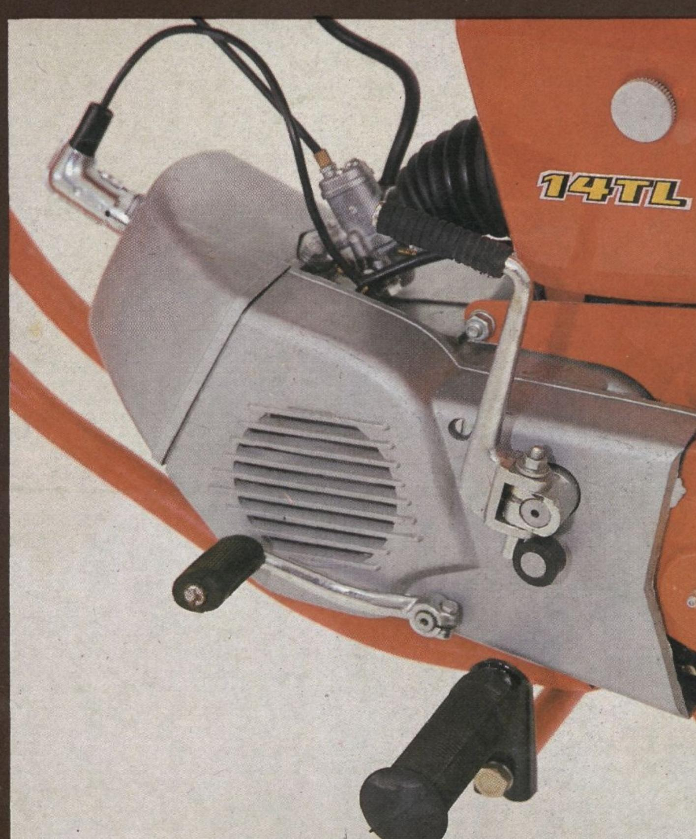
**TOMOS 14 TL** ima magnetsko paljenje, napon 6 V 17 W/5 W. Iznad levog odupirača za nogu, nalazi se nožni pokretač — kickstarter. Sa desne strane motora učvršćena je nožna poluga za zadnju doboš kočnicu. Takođe je i prednja kočnica doboš, a ima ručnu polugu. Dobro ublaživanje vozila izvedeno je spreda pomoču uljno opružne teleskopske viljuške, a pozadi pomoču njihajuće viljuške, preko opružnih hidrauličnih ublaživača. Hod prednje viljuške je 65 mm, hod zadnjih opružnih ublaživača 60 mm.
