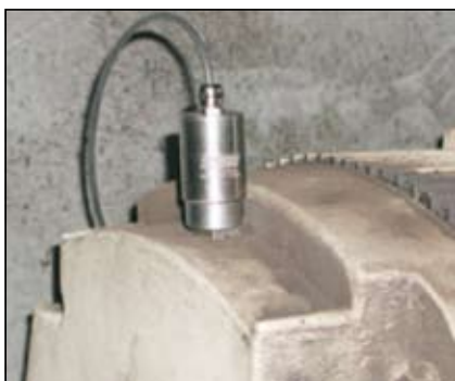
Slika 3. Ultrazvočni senzor Ultra Trak 750 (a) in namestitvev na okrov stroja (b)
