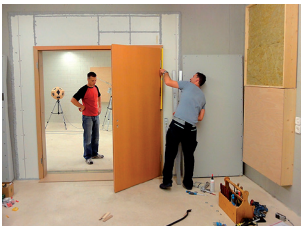
Preizkus zvočne izolativnosti dvokrilnih vrat (foto: arhiv LIP Bled d.o.o.)
