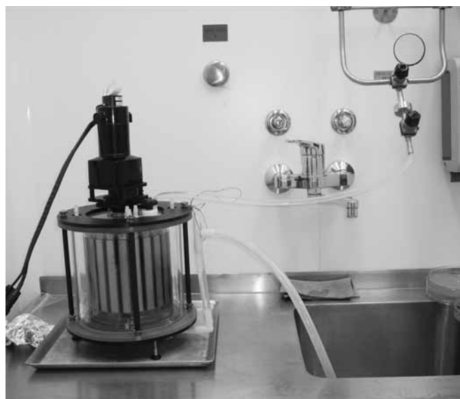
Slika 2: Laboratorijska naprava za proučevanje biofilmov Biofilm Annular Reactor, ki je s cevjo direktno povezana na industrijski sistem za razdeljevanje prečiščene vode.
