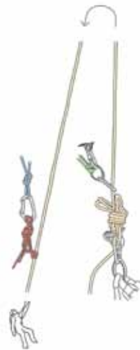
Slika 2b: Priprava na prenos obremenitve v novo sidrišče
