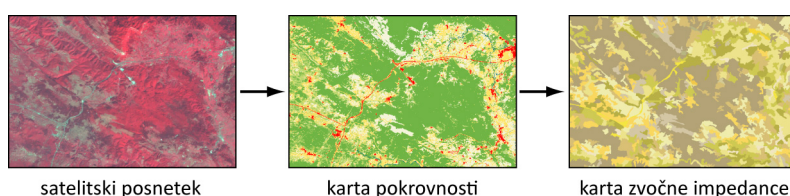
Slika 44: Poenostavljen prikaz procesa izdelave impedančne karte iz podatkov daljinskega zaznavanja.
