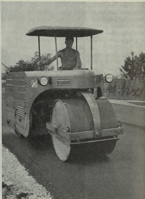
Sl. 4. Vibracijski valjar »Dingler«, 4 tone
