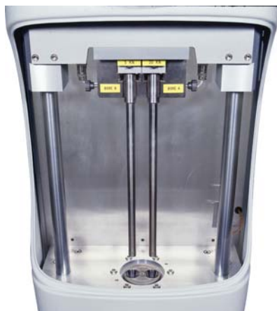
Slika 1: Primer enokapilarnega in dvokapilarnega reometra (vir: CEAST)
