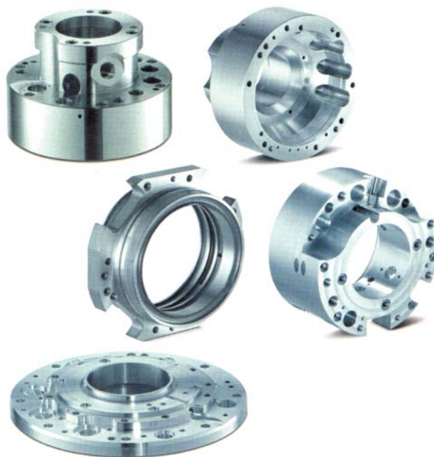
Značilna paleta obdelovancev, kakršne je mogoče obdelati z obdelovalnim centrom MC 826/MT-S.
