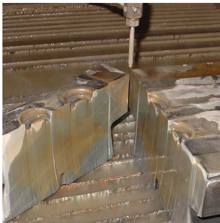
Rezanje utopa za kovanje, debeline 220 mm, z namenom opazovanja obrablenosti orodja
