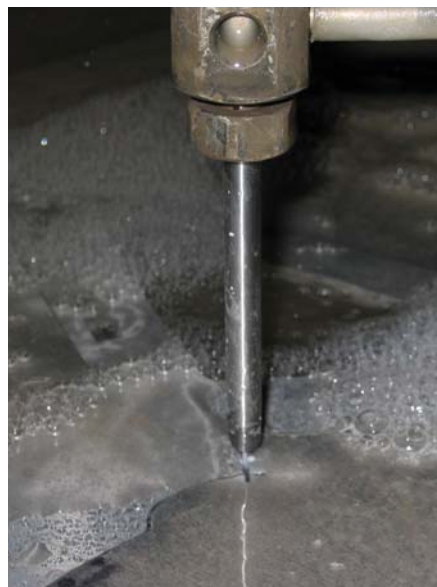
Slika 1: Levo – prebijanje 20-milimetrske nerjavne pločevine s 5-kW CO 2 laserjem (rezanje poteka pri hitrosti 120 mm/min. Fotografija je bila narejena v podjetju Kovinski izdelki, Filip Povše s.p., Šentrupert). Desno – rezanje 20-milimetrske nerjavne pločevine z AVC s hitrostjo 80 mm/min. Fotografija je bila posneta v LAT na Fakulteti za strojništvo v Ljubljani.
