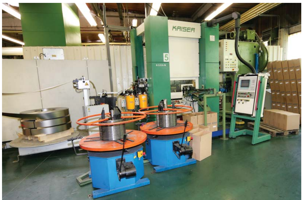
Stroj za izdelavo zaslona, enega izmed kovinskih delov za registratorje
