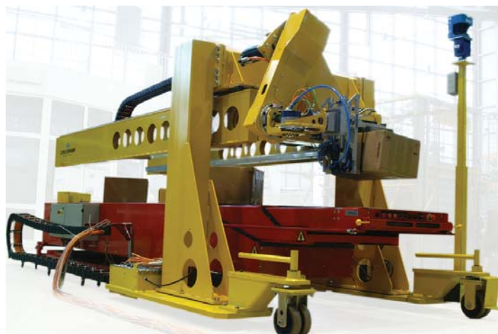
Šestosni hibridni robot s strojnim vidom za razkladanje teh vrha naloženih zabojnikov (foto: STROTHMANN)
