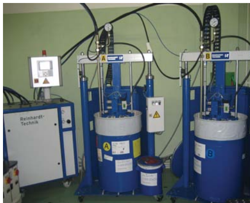
Slika 3: Mešalna postaja z dozatorjema in mesto postavitve silikonskih posod
