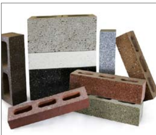
Pozzotive Plus zaključni betonski zidaki in betonski zidaki podjetja Kingston Block: oba izdelka sta v 30 odstotkih izdelana iz odpadnega in recikliranega stekla kot nadomestka cementa Portland in v 50 odstotkih iz odpadnega recikliranega gradbenega agregata lokalnega izvora.
