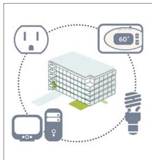
Convia Energy, infrastrukturni upravljavnik: Convia je podjetje Hermana Millerja, ki v partnerstvu z vodilnim omrežnim distributerjem Wiremold ponuja modularno energetske upravljanje. Luči, stikala, senzorji, timerji in druge električne naprave so povezani v premišljeno narejeno upravljano napravo, ki omogoča merjenje in optimalne prilagoditve energetske porabe objekta.
