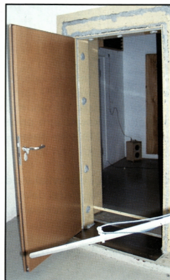
Laboratorij za akustiko v Sauerland Test Centru - testiranje krila SSK 3, 02.09.2003
