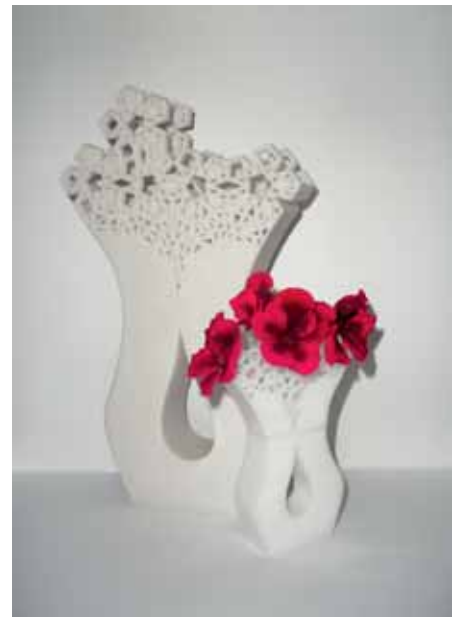
Slika 2: Končni večfunkcionalni vazi, iztiskani s tiskalnima ZPrinter 450 in RapMan 3.1.
