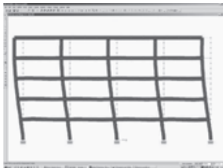
Regularna konstrukcija tipični okvir. Nihajni čas je 1,8 s. Regular structure typical frame. Oscillation time is 1,8 s.
