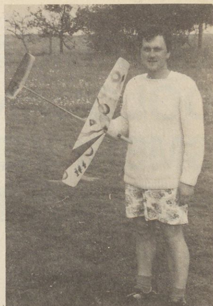
Slika 6. Posebna zanimivost na tekmovanju je bil model Boga Štampiharja, saj je bila na njem prvič v tej kategoriji modelov uporabljena tehnika t.i. »Air-brusha« (zračnega čopiča), s katero se da model pobarvati izredno zanimivo, ne da bi se njegova teža zaradi nanosa barve preveč povečala.
