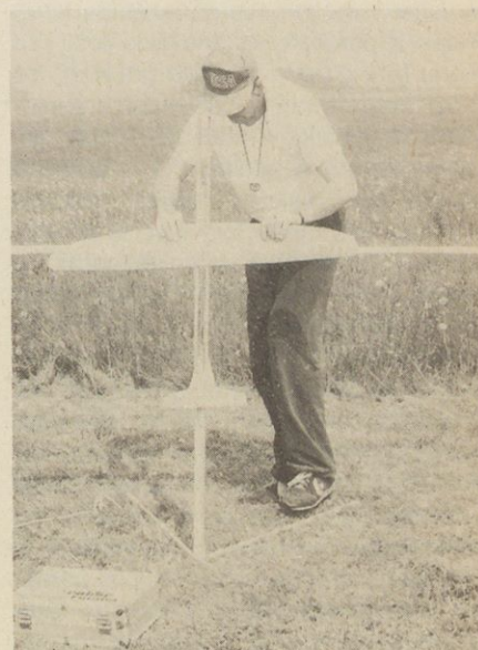
Slika 7. Vrhunski model Bogdana Makuca s precej veliko razpetino kril (1160mm) in motorjem, nameščenim pod krilom, med pripravami za štart.
