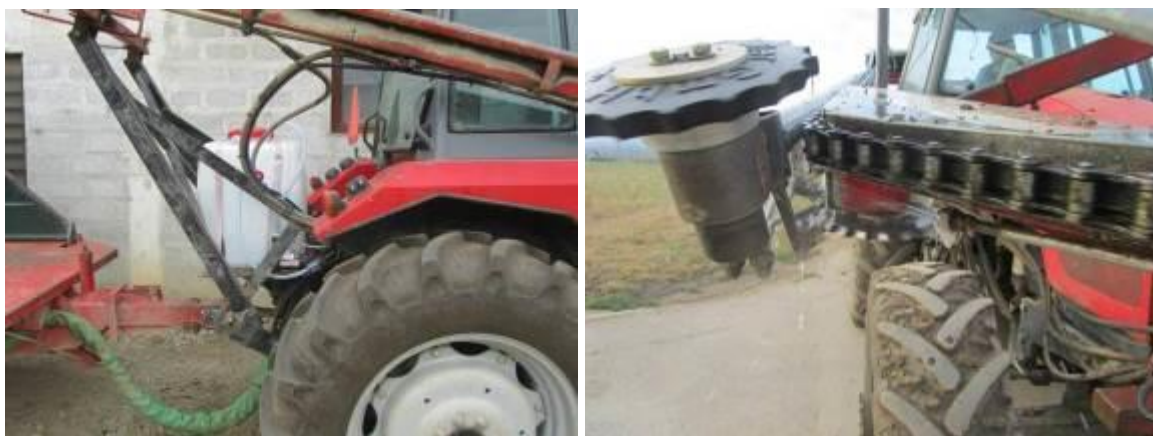
Slika 10: Prototip škropilnice, ki omogoča razkuževanje trgalne glave ob obiranju hmelja.
