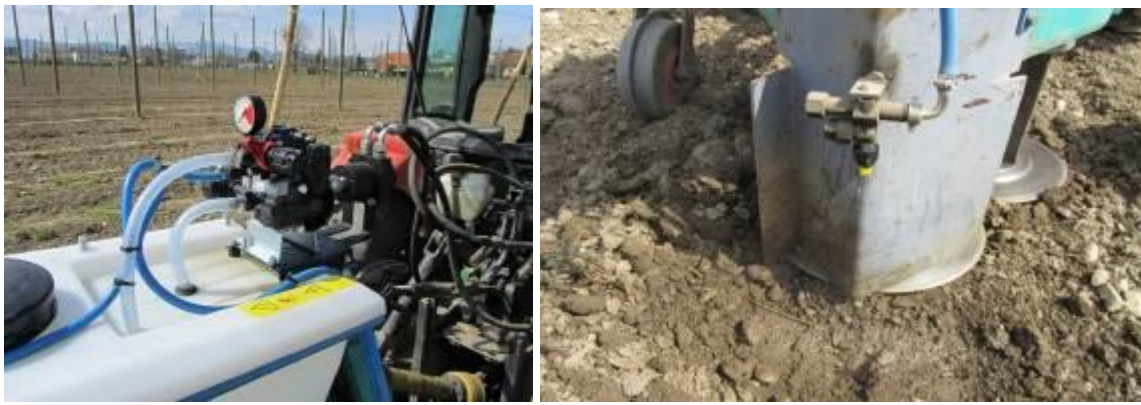
Slika 9: Prototip škropilnice, ki omogoča razkuževanje rezalnikov hmelja ob rezi.
