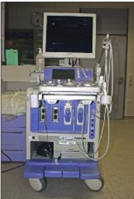
Slika 3. Doplerski aparat Aloka SSD-5500, ki ga uporabljamo za ocenjevanje lokalne arterijske podajnosti.
