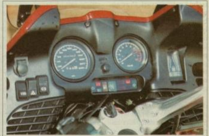
Popolnost in preglednost. Desno od merilnikov je digitalni prikazovalnik količine goriva, temperature olja, izbrane prestave in ura. Levo so stikala električnega gretja krmila, varnostnih utripalk in kontrole ABS. Nad njimi je 12 V vtičnica.
