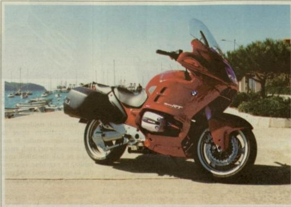
Elegantno oblikovan prednji del odlično štiti motorista. Steklo vetrnega ščitnika je električno nastavljivo. Nizko postavljeni vzvratni ogledali se skrivata za smerniki.
