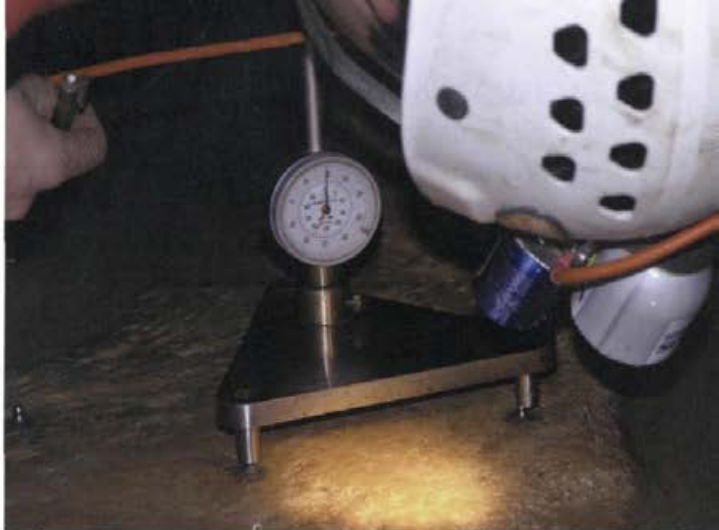
Hitrost jamskih procesov ugotavljamo s pomočjo mikrometra. (Foto: Društvo ljubiteljev Križne jame)
