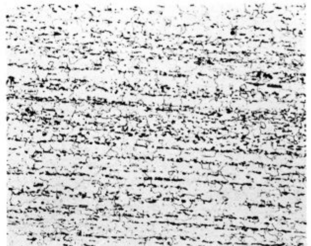
Slika 8 Struktura z veliko količino perlita — 100 ×
