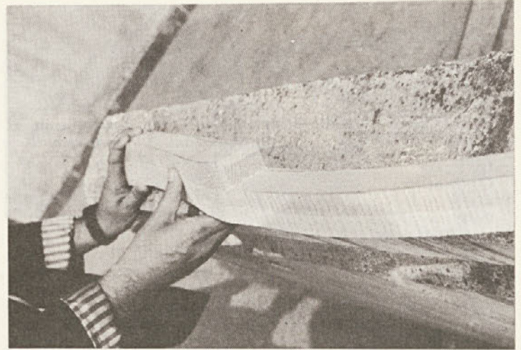
»Izum«: spajanje z železnimi sponkami, kar se še kako pozna pri nadaljni obdelavi
