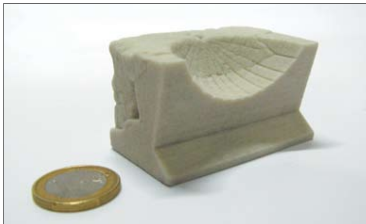
Najmanjši model, namenjen za izdelavo serijskih keramičnih izdelkov, pa je zaradi svoje majhnosti izdelan tako, da ohranjenega dela ure in domodeliranega dela ni možno razstaviti.
