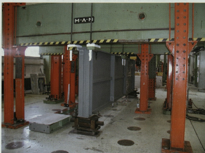
Slika 3 • Bočno podpiranje zgornje pasnice z opornimi okvirji
