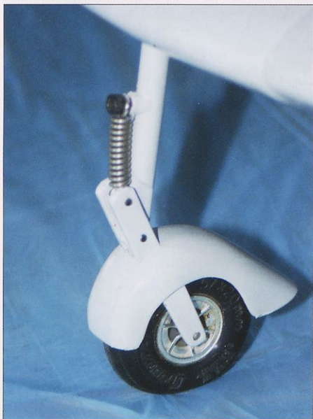
Noga glavnega podvozja je opremljena z vzmetjo.
