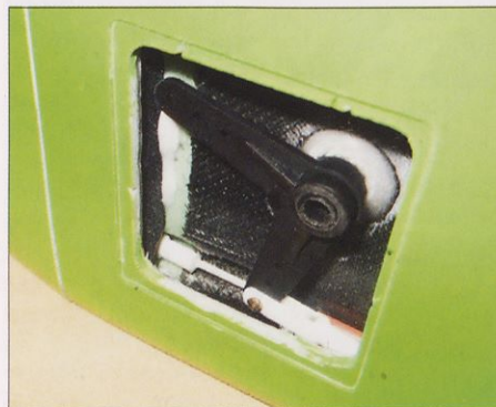
Lepo se vidita prilepljena puša in L-vzvod.
