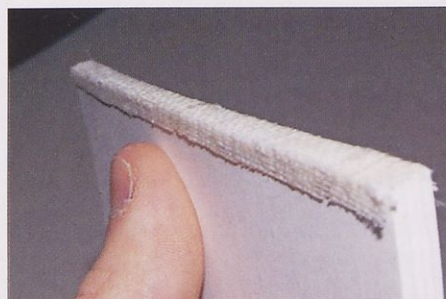
Slika 11. Organtin v obliki črke U se uporablja za boljši povezavi listov bloka.
