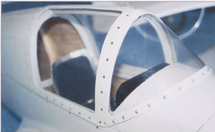
Da bi se čim bolj približal verodostojni obliki pravega letala, je Sveti na okvir kabine opremil tudi s kovčami.
