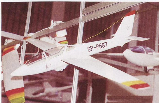
Podjetje Gerasis je predstavilo že izdelane letalske polmakete raznih velikosti in tehnologij. Model akrobatskega letala fox, na sliki, je izdelan v kalupu in to v celoti iz steklenih vlaken. Ima razpnetino kril 2 m ter vzletni RG 15. Največji model ventus 2 C z razpnetino 6 m pa tehta 13 kg.
