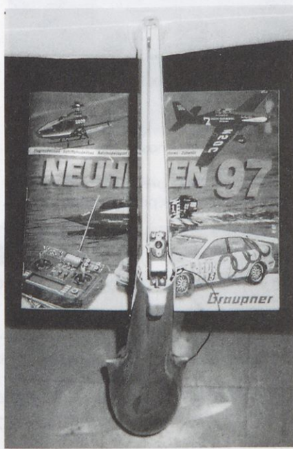
Montaža servomehanizma višinskega krmila
