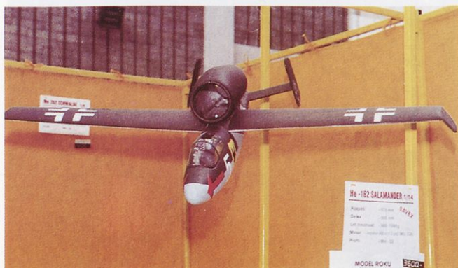
Savex izdeluje polmakete letal iz steklenih vlaken, ki naj bi jih poganjal elektromotor tipa 400 ali 500. Na sliki je nagrajeni model He-162 salamander.
