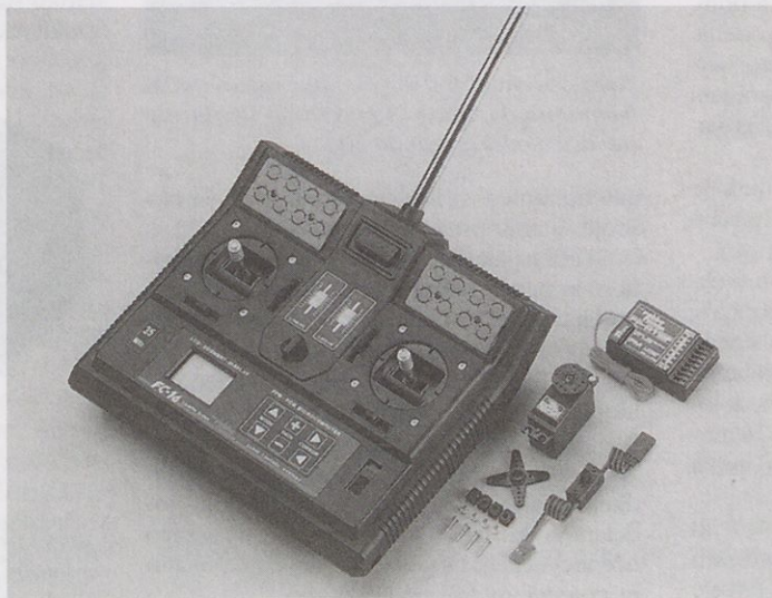
V kompletu dobimo oddajnik, sprejemnik, servomehanizem, pribor in par kristalov.
