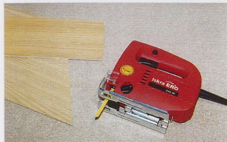
Slika 4. Za žaganje furniranega lesa uporabite žagin list s čim finejšimi zobci.
