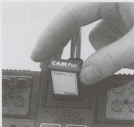
Tako vložimo CamPac, dodatni računalniški pomnilnik, ki omogoči povečanje števila nastavitvev modelov tudi do 100!
