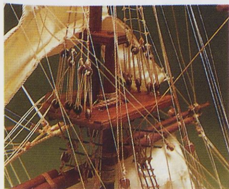
Slika 6. Pogled na enega izmed jambornih košev
