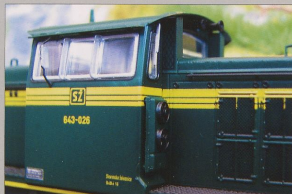
Kabina modela SŽ 643-026 se razlikuje od drugih dveh modelov SŽ 642 po velikosti in razdelitvi oken na tri dele. Na vseh kabinah je pritrjen hladilnik za klimo.
