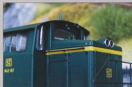
Model lokomotive SŽ 642-187 se razlikuje od drugih dveh modelov po vodoravno postavljenih zgornjih reflektorjih spredaj in zadaj ter povešenem krajšem zadnjem delu.
