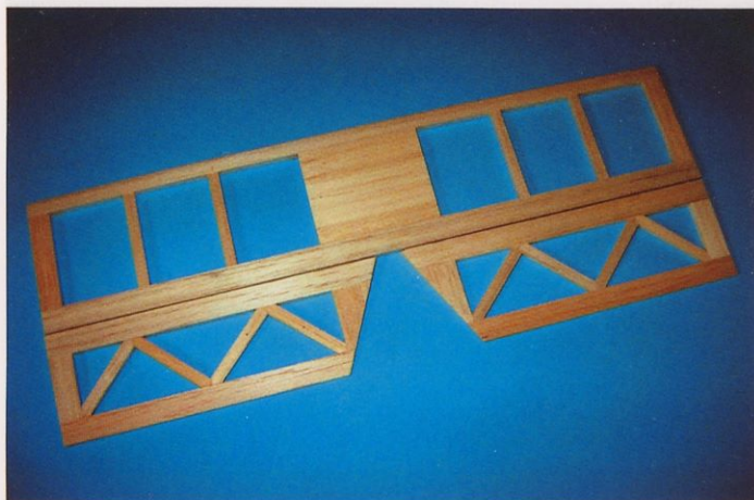
Če smo pri izdelovanju sestavnih delov pazljivi, so take repne površine zelo lahke in dovolj trdne. K trdnosti delov pozneje prispeva tudi folija za prekrivanje.
