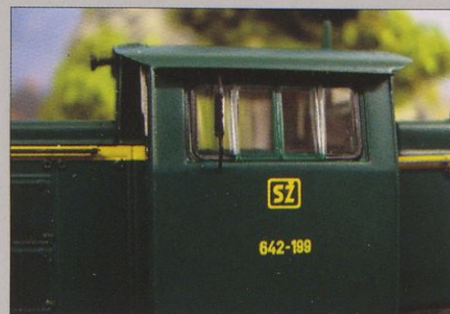
Pri modelih SŽ 642-187 in SŽ 642-199 sta kabini enaki, okna pa so razdeljena na štiri dele.
