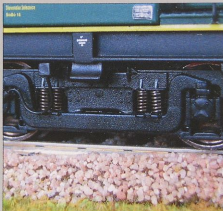
Stranski deli podstavnih vozičkov, kjer so vgrajene tudi štiri kovinske vzmeti, so zelo natančno izdelani.
