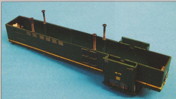
Ohišje je na podvozje pritrjeno s štirimi vijaki.
