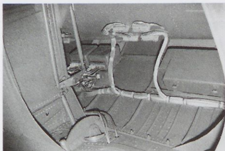
Notranjost desne strani trupa s kopico rumenih električnih kablov
