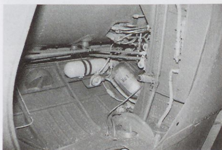
Notranjost leve strani trupa s krmilnimi mehanizmi in jeklenkami. Notranjost je sivolične barve, jeklenka pa je rumena.
