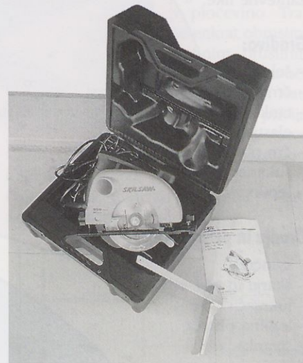
Slika 7. Električna krožna žaga SKIL 5240 je spravljena v trdnem plastičnem kovčku, ki omogoča preprosto ter predvsem varno prenašanje in shranjevanje tega zelo uporabnega orodja.
