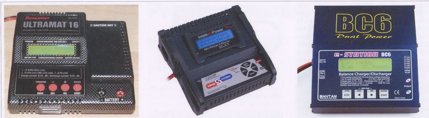
Slika 5. Polnilniki Li-po z vgrajenim balanserjem ter delovanjem na 12 V in 230 V
