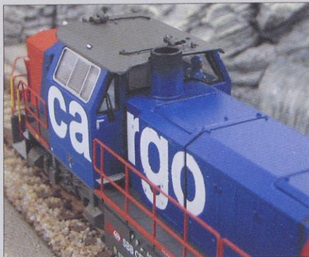
Slika 4. Na modelih SBB Cargo in BLS se izpušni dimnik in vrata v strojevodsko kabino nahajajo na desni strani.
