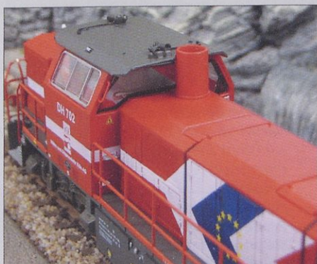
Slika 5. Na modelih HGK, Acerealia, MRCE in CFL sta izpušni dimnik in vrata v strojevodsko kabino na levi strani. Zaradi dimnika so v drugačnem položaju tudi hupe na strojevodski kabini.
