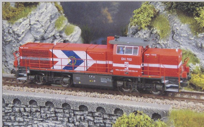
Slika 3. Vossloh G 1700 BB v merilu 1 : 87 (H0) operaterja Häfen und Güterverkehr Köln (HGK) se od modela BLS in SBB Cargo razlikuje po vratih na ohišju, ograjah, žarometih in velikosti zalogovnika pod lokomotivo.
