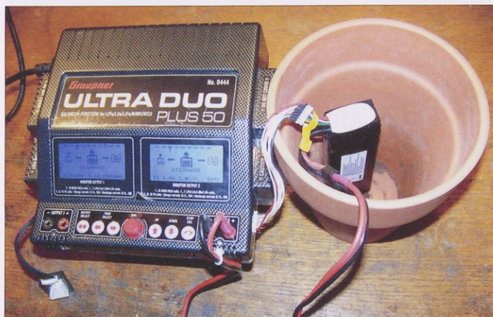
Slika 3. Varno polnjenje in praznjenje baterije v lončeni posodi
