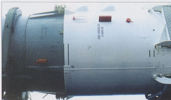
Spodnji del montažno zaščitnega bloka s prehodnim odsekom
