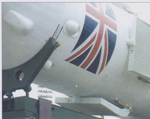
Zgornji del aerodinamičnega okrova glave z vidnim opornim mestom
