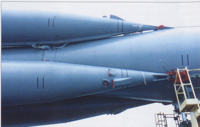
Bočni bloki so prek kroglastih opornikov na vrhu konusov pritrjeni v posebne konzole na drugi stopnji.
