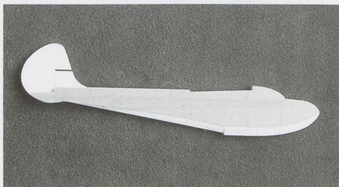
Slika 8. Vodilni črti na bokih trupa zarišemo ob šablono.
