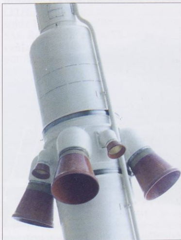
Šobe raketnega motorja na spodnjem delu DU SAS
