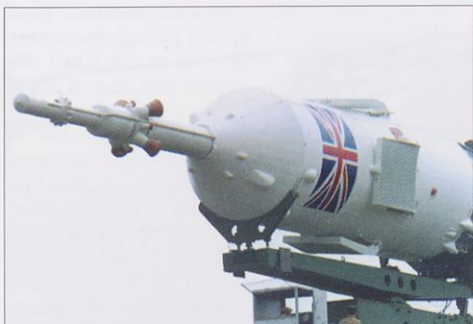
Na vrhu rakete je pogonska naprava sistema za reševanje posadke (DU SAS) v primeru nesreče
