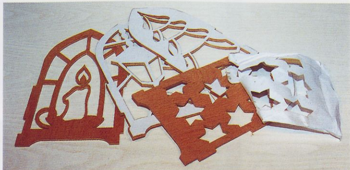
Slika 1. Velika prednost odstranljivega lepila Scotch Attaca-Stacca je v tem, da z njim premazano fotokopijo po izžaganju preprosto potegnete stran.
