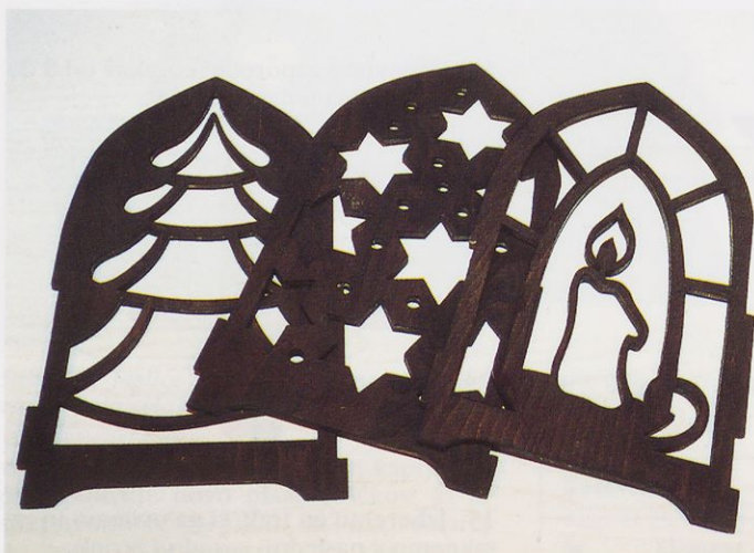
Slika 2. Tri od štirih izrezljanih, obrušeni in z lužilom prebarvanih stranic laterne; vidne so tudi luknjice za držalo svečke, ki jih izvrtajte z 2-milimetrskim svodom.
