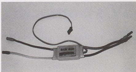
Slika 2. Kontronikov easy 3000 je visokofrekvenčni mikroprocesorski krmilnik s funkcijo BEC in zavoro. Napajamo ga lahko s 6 do 12 celicami, pri čemer trajni tok ne sme preseči 35 A.
