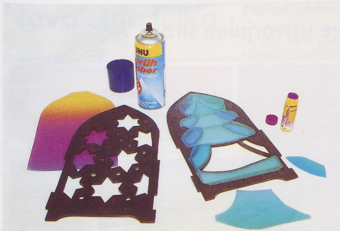
Slika 6. Za večje površine je najprimernejše lepilo v prškici (levo), za lepljenje manjših kosov pa lepilo v stiku (desno).
